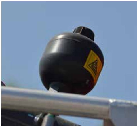
Gli accumulatori pneumatici devono essere smontati per verificare la corretta pressione interna
