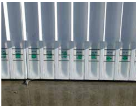
Controllo di portata degli ugelli
