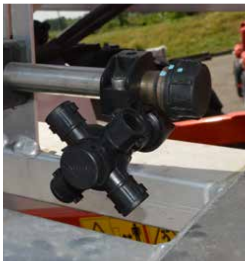
Per evitare l'ingresso di polvere o insetti nel circuito si possono collocare i porta-ugelli in posizione neutra (foro chiuso)
