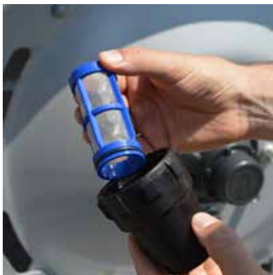
Il controllo dei filtri delle sezioni fornisce anche indicazioni su eventuali problemi alla pompa principale
