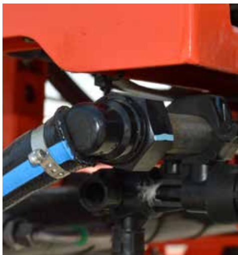
Raccordi in plastica e filtri sono gli elementi più soggetti a danni da gelo
