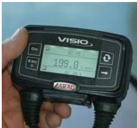
Flussimetro elettronico per la verifica dell'effettiva portata della pompa
