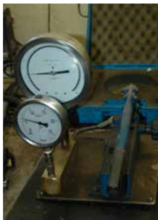
Controllo funzionale: verifica della precisione del manometro
