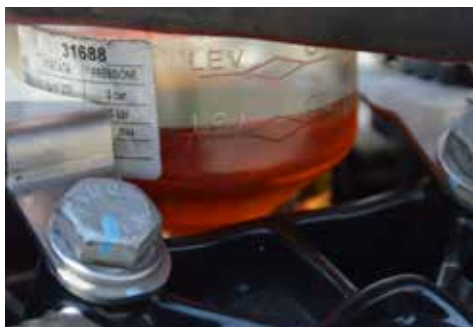
Tenere sempre d'occhio il livello dell'olio nella pompa idraulica
